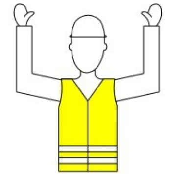
ALTO O PARADA DE EMERGENCIA
